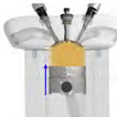
Figura 4.9. Comprimarea la motoarele Diesel (Sursa: Learn Engineering).
