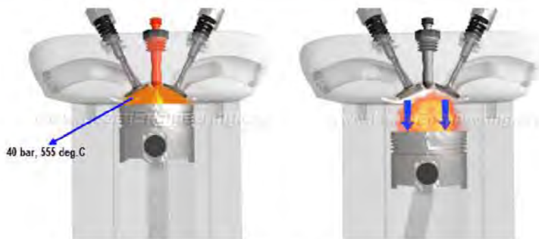
Figura 4.10. Arderea și destinderea la motoarele Diesel (Sursa: Learn Engineering).
