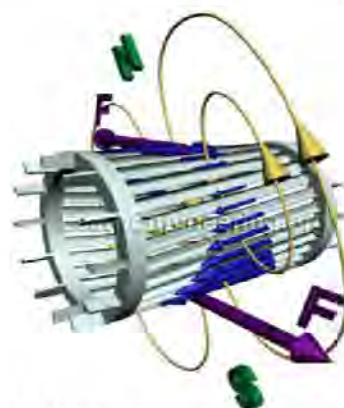
Figura 4.16. Câmpul magnetic rotitor generat de curenții statorici (Sursa: Learn Engineering).
