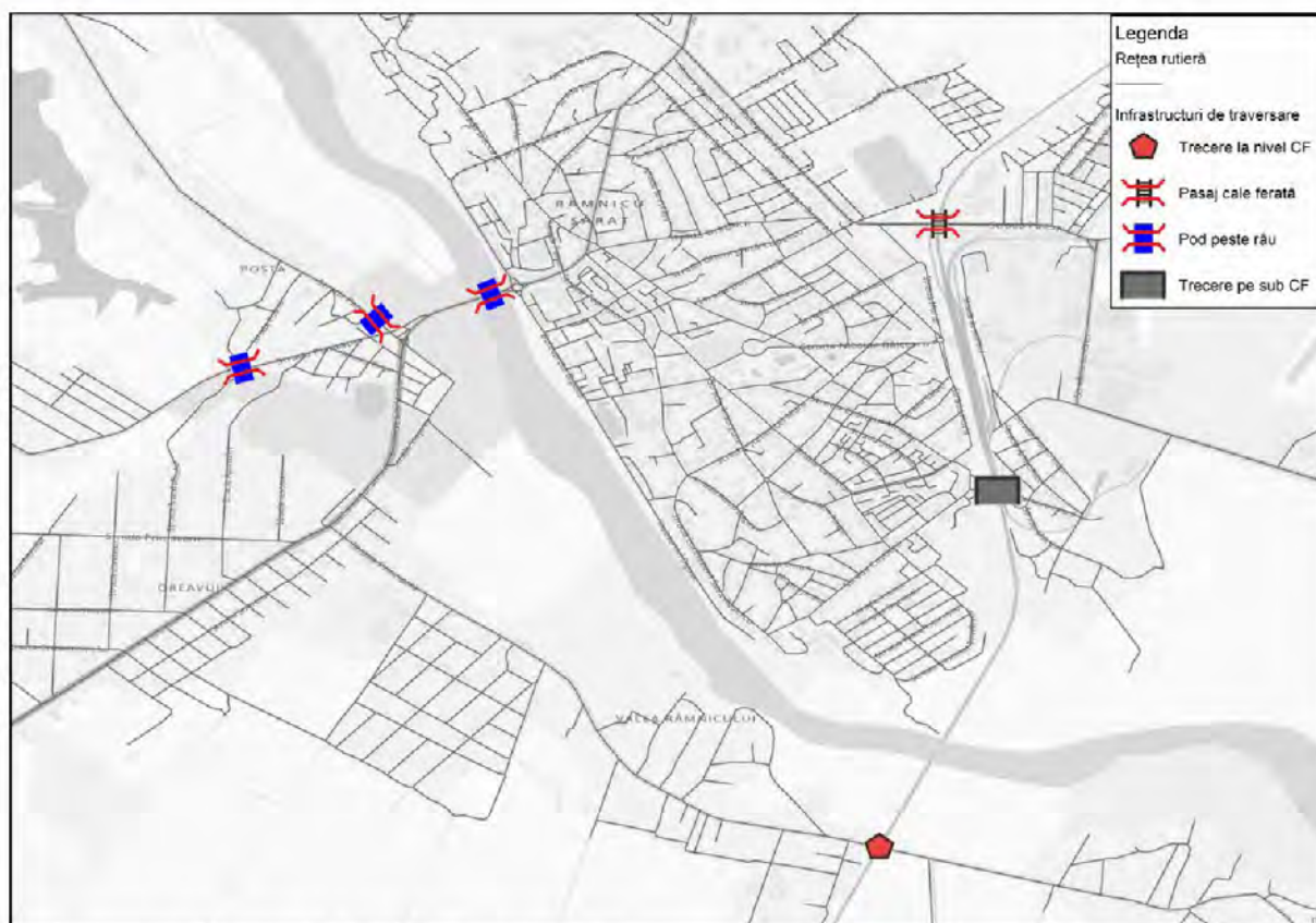
Figura 3.16. Infrastructuri de traversare – Municipiul Râmnicu Sărat.
